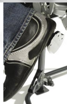
A partire dal 2006: "Dentini" per un'adoperazione facile del cavalletto laterale.
