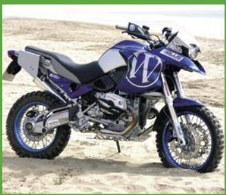
"Extreme": spazio a terra incrementato + sistema di fissaggio che riduce vibrazioni.
