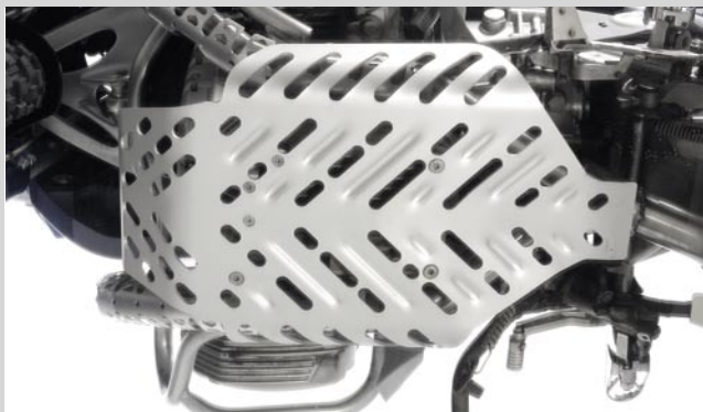
"Dakar" + "Extreme": 6 punti di ancoraggio, piastra protezione ultraresistente + rigida
