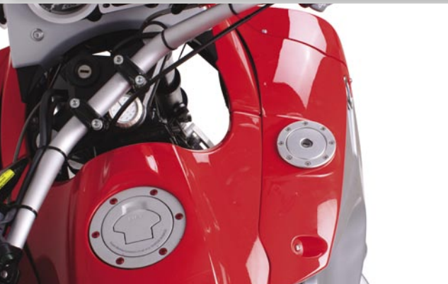
Rifornire entrambi i serbatoi attraverso un solo accesso
